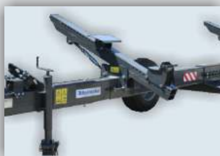
2 Wózek czterokołowy (skrętny dyszel, dodatkowe podpory hederu) Four-wheel trailer (turning drawbar, additional supports for a header) Тележка четырехколесная (поворотное дышло, дополнительные опоры для жатки) Vierradwagen (Drehdeichsel, zusätzliche Stützstangen des Mähbalkens) 2 essieux (essieu avant pivotant, supports supplémentaires pour coupe)
