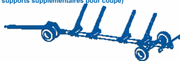
2 Wózek czterokołowy (skrętny dyszel, dodatkowe podpory hederu) Four-wheel trailer (turning drawbar, additional supports for a header) Тележка четырехколесная (поворотное дышло, дополнительные опоры для жатки) Vierradwagen (Drehdeichsel, zusätzliche Stützstangen des Mähbalkens) 2 essieux (essieu avant pivotant, supports supplémentaires pour coupe)
