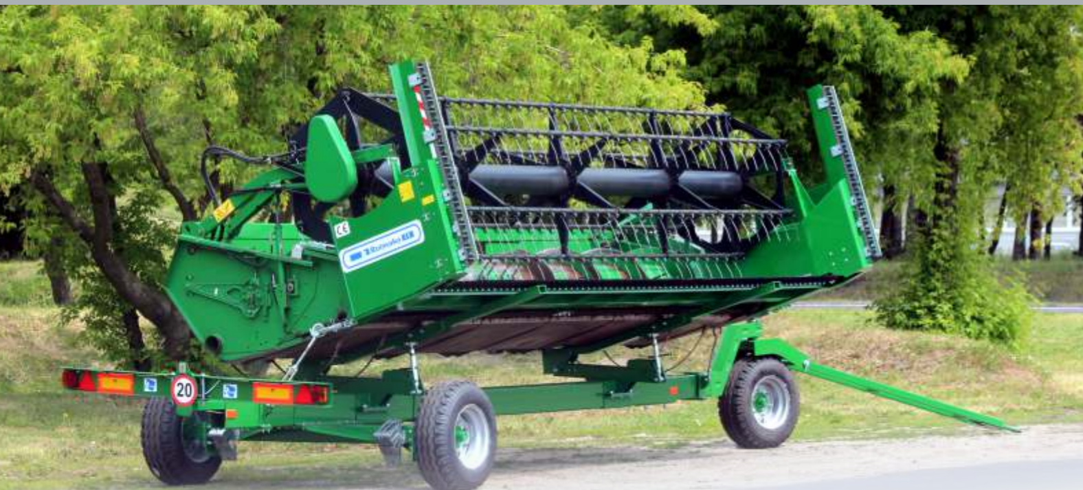
1 Wózek dwukołowy (sztywny dyszel z kołem podporowym) Two-wheel trailer (rigid drawbar with a supporting wheel) Тележка двухколесная (неподвижное дышло с опорным колесом) Zweiradwagen (steife Deichsel mit Stützrad) Simple essieu (poutre fixe et essieu fixe)
