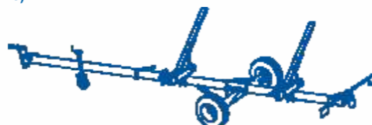
1 Wózek dwukołowy (sztywny dyszel z kołem podporowym) Two-wheel trailer (rigid drawbar with a supporting wheel) Тележка двухколесная (неподвижное дышло с опорным колесом) Zweiradwagen (steife Deichsel mit Stützrad) Simple essieu (poutre fixe et essieu fixe)
